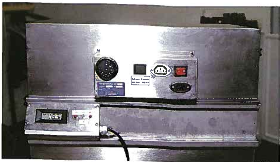
Foto 3: Foto Jakel-Gerät: Versuchsweise wurden Wabenstücke mit fest kandierte Honig im Abdeckelungswachsschmelzgerät der Firma Jakel verarbeitet und der Honig auf Hitzeschäden untersucht. (Foto: Armin Spürgin)
