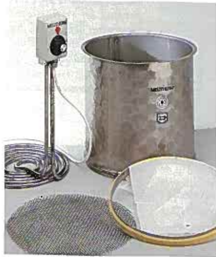
Foto 1: Das „Melitherm“ von Spürgin: In den Edelstahlbehälter rechts oben wird das runde grobe Gitter eingelegt. Darüber wird ein Sehtuch mittels Spannungring gelegt und darauf kommt der elektrische, stufenlos regelbare Heizstab. Das „Melitherm“ verflüssigt und filtert kandierte Honige in einem Arbeitsgang.
